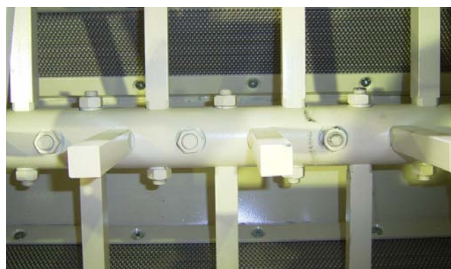
Желоб остеоломателя с поверхностью с перфорированными ячейками и ударные прямоугольные штифты
